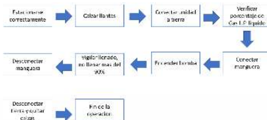
Diagrama de flujo de las actividades de la pipa al llenado del tanque.
